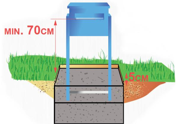
1. Die Abmessungen des Lochs X und Y entsprechend den Grundabmessungen des gewählten Modells + 15 CM. Graben Sie das Loch in einer Tiefe von  $\pm 60$  CM. Gießen Sie Beton in das Loch bis zu einer Höhe von  $\pm 35$  CM.
